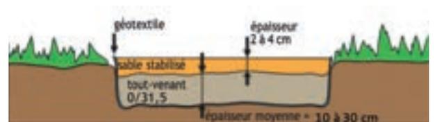
Le fond de forme doit être compacté à l'aide d'une plaque vibrante, et respecter les pentes de l'ouvrage qui seront assurées pour chaque couche d'assise, de pose, et de revêtement.
