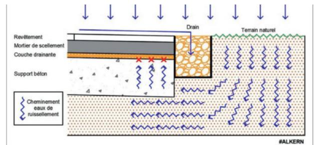
Un drainage périphérique de l'ouvrage est notamment indispensable lorsque le niveau du terrain naturel est plus élevé que le niveau de la couche drainante afin que les eaux de ruissellement ne soient pas renvoyées vers le revêtement (cf. schémas ci-contre).
