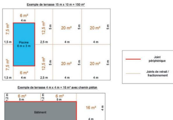
Les joints périphériques permettent la déformation longitudinale du support et du revêtement autour de points fixes rigides (mur, coffrage de piscine, insertion de mobilier, réservations, ...). Le non respect de ces derniers peut mener à la fissuration du support et du revêtement à proximité de ces éléments.
