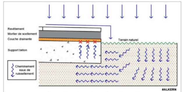
Un drainage périphérique de l'ouvrage est notamment indispensable lorsque le niveau du terrain naturel est plus élevé que le niveau de la couche drainante afin que les eaux de ruissellement ne soient pas renvoyées vers le revêtement (cf. schémas ci-contre).
