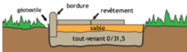
Si le sol est imperméable, un drainage du lit de pose doit être réalisé. Pour cela, une couche de sable grossier sera déposée en périphérie, complétée éventuellement par une évacuation en fonction de la configuration de l'ouvrage.
